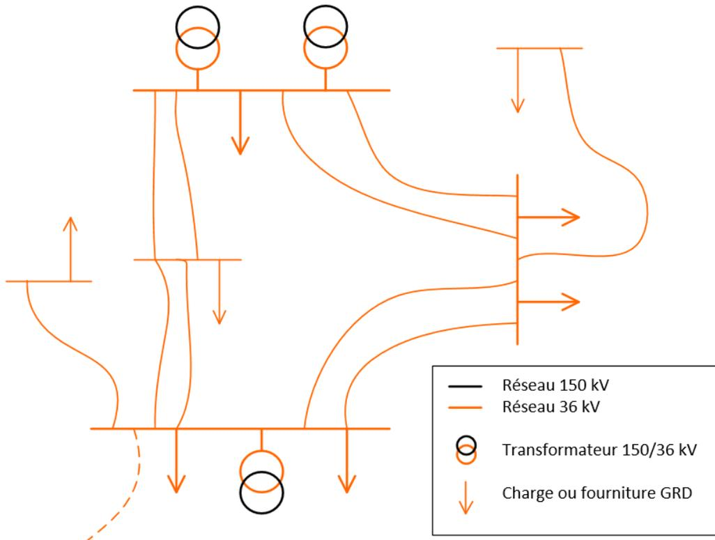
Figure 1.8 : structure type d'une poche 36 kV
