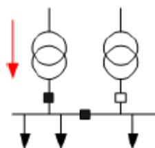
Figure 3.3 : Mise hors tension d'un transformateur de réserve
