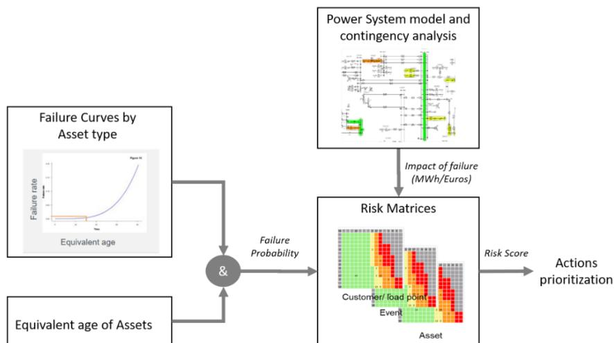
Figure 2.10 : Prise de décision future basée sur le risque pour la gestion du déclassement ou du remplacement des équipements
