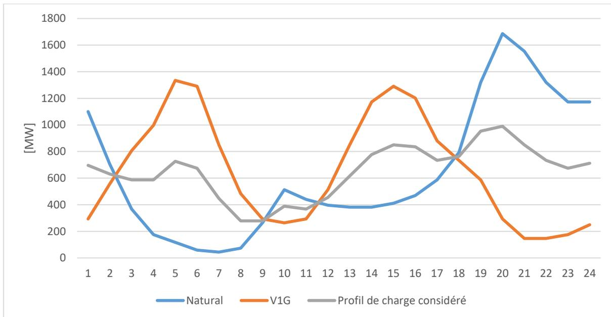
Figure 3.1: Profil de charge global des véhicules électriques
