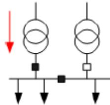
Figure 4.4: Mise hors tension d'un transformateur de réserve
