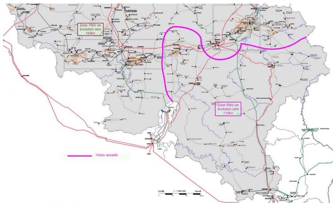
Figure 4.1 : Zones 70 kV évoluant vers 150 ou 110 kV
