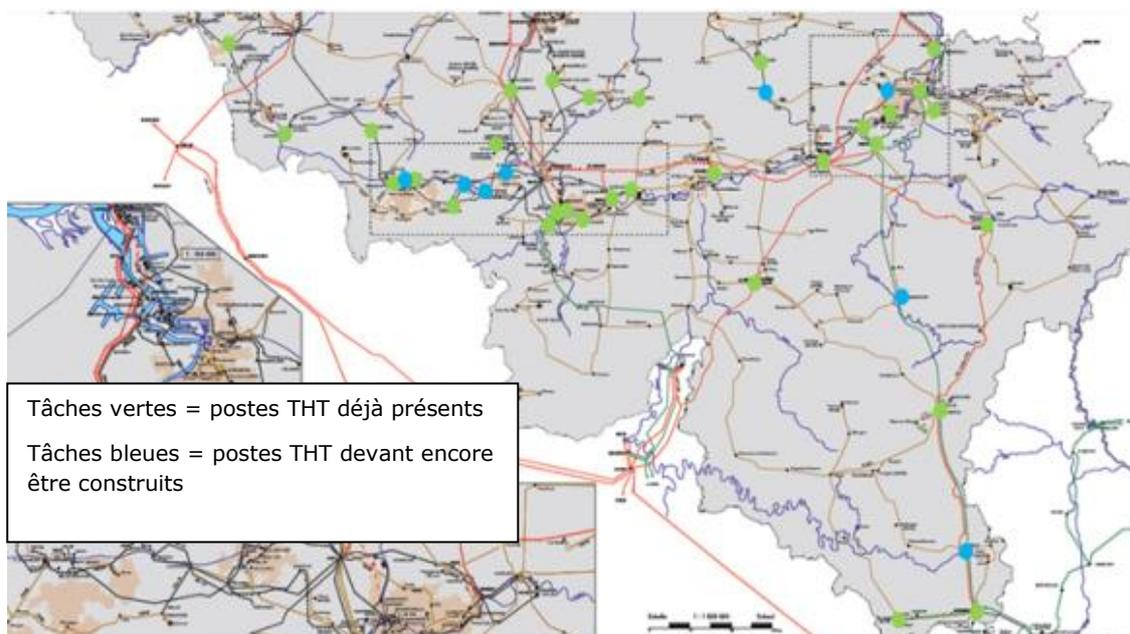
Figure 4.2: Représentation géographique de la localisation possible de hubs de productions décentralisées en Wallonie THT/36 kV de 125 MVA (THT=Très Haute Tension)
